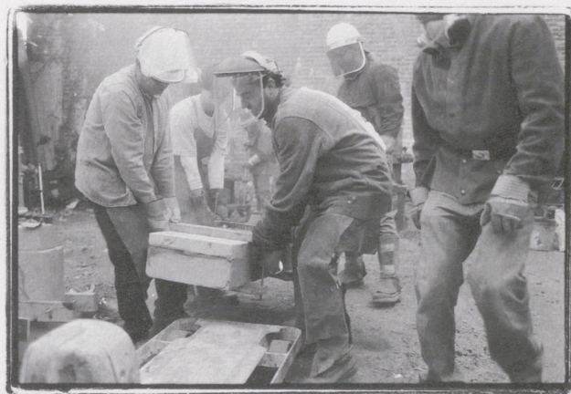
LINING UP SAND MOLDS FOR THE IRON POUR
